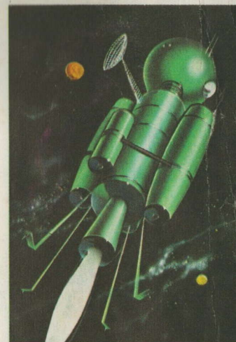
Astronef atomique. Dans un moteur nucléaire spatial, l'hydrogène est porté à haute température par fission d'uranium et le gaz, ainsi dilaté, s'échappe par l'arrière en produisant la poussée.
